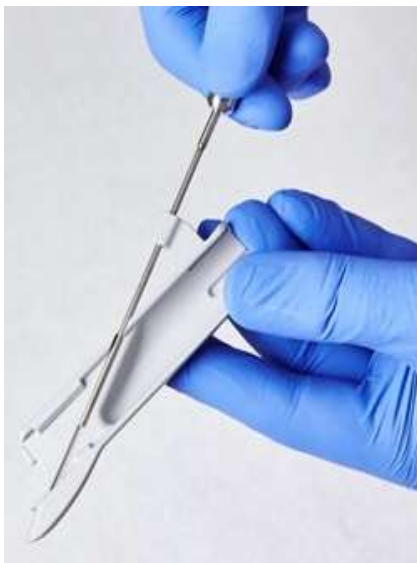
Obrázek 6: Vložení kanyly jehly do plastového pouzdra
