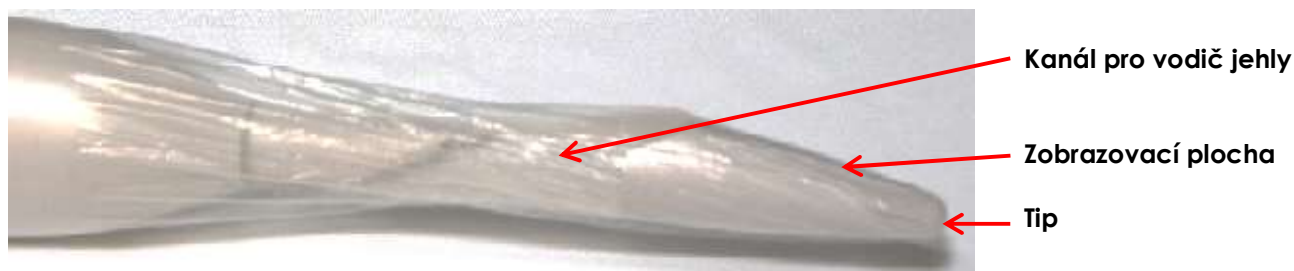
Obrázek 12: Sonda EV29L s návlekm naplněným gelem
